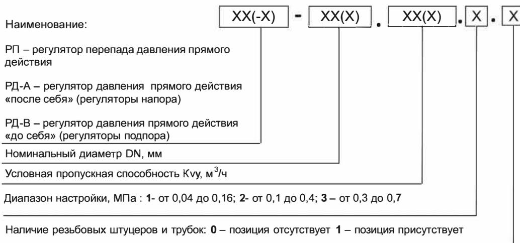
Рисунок 1 Структура условного обозначения регуляторов
